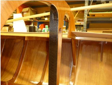
Thomas Bergner Bootsbau baut die Schalen. Als Kasko kommen diese nach Oberglatt ZH, in die Bootswerkstatt Naef, wo Spanten und Deck montiert werden. Danach werden die Beschläge mit grosser Sorgfalt eingebaut.
